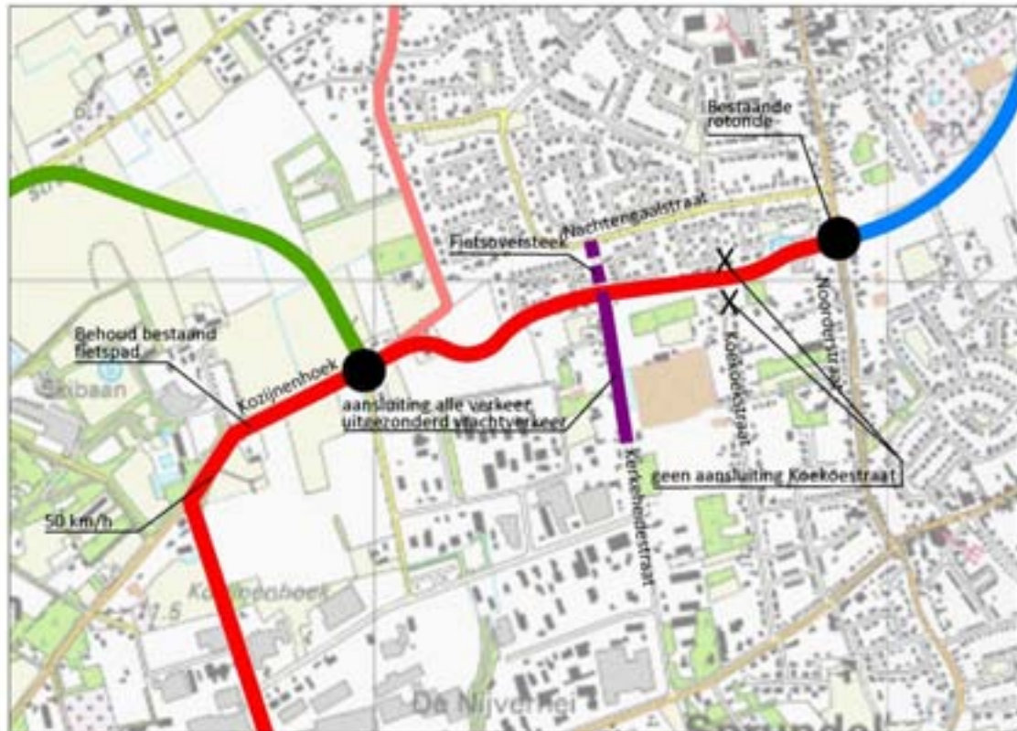
Figuur 3.2 Wegontwerp A: Oostelijk tracédeel
