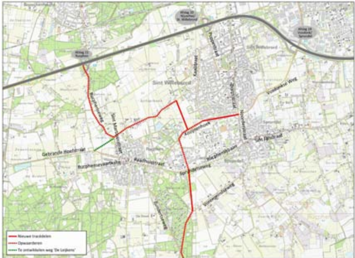
Figuur 3.6 Fase 2 - situatie na 2020: tracédeel A, B én C (bron Verkorte Planstudie)
